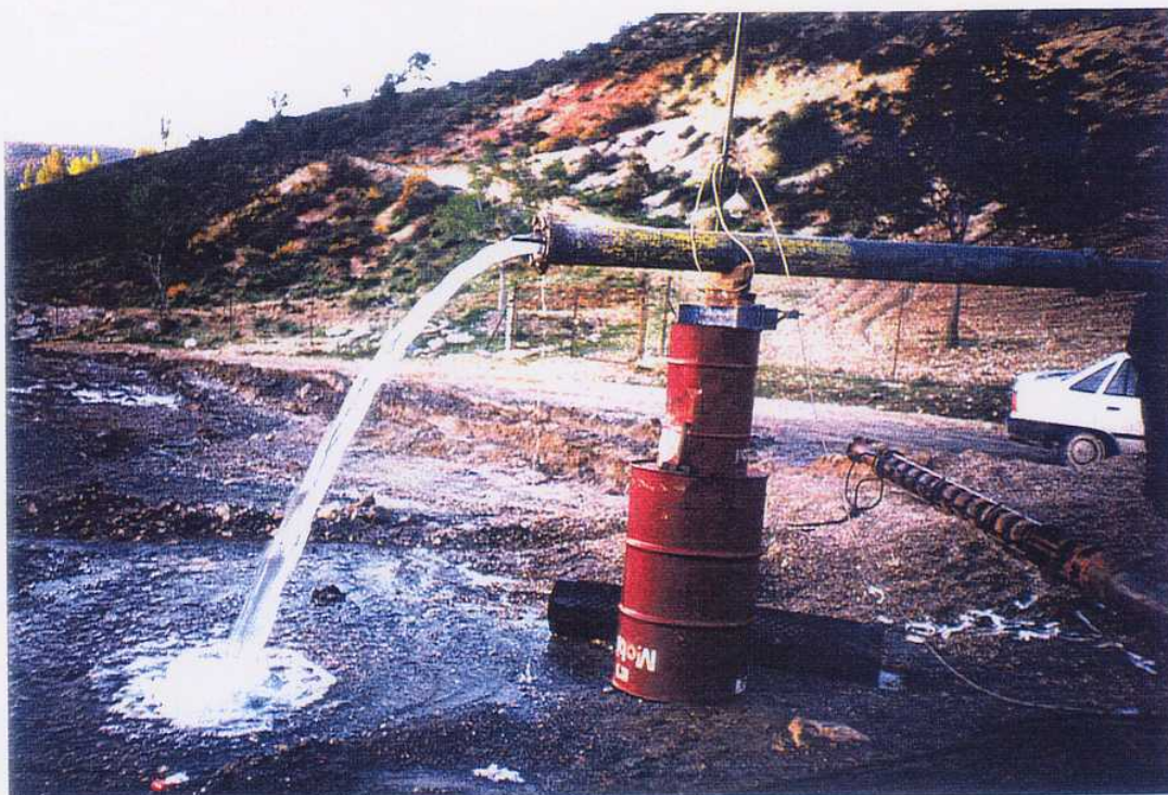
FOTO 18. Segundo ensayo de bombeo a caudal constante de 9 l/s del SONDEO ATASCADEROS. Santiago-Pontones (Jaén).
