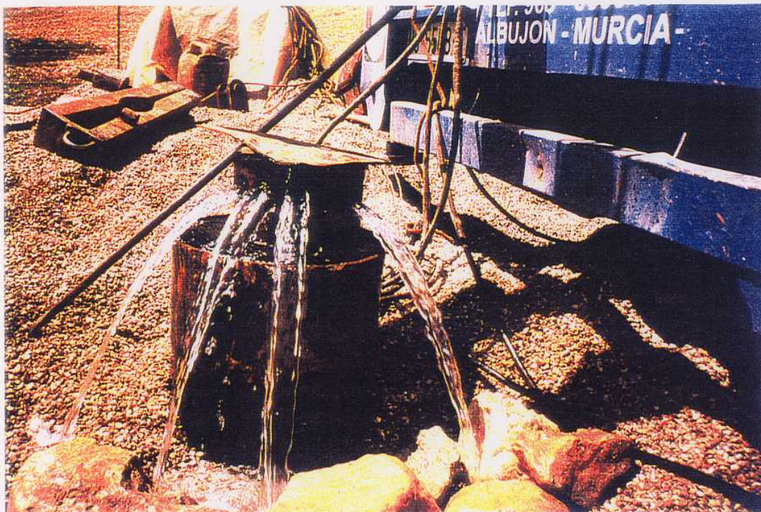
FOTO 13. El caudal surgente del SONDEO ATASCADEROS se aforó en 3,1 l/s, justamente antes del inicio del ensayo de bombeo. Santiago-Pontones (Jaén).
