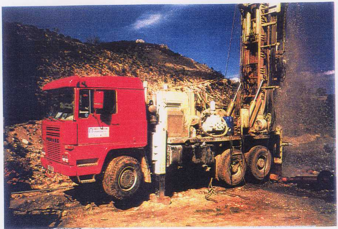
FOTO 1. HIDROELECTRO DE CAZORLA, S.C.A. ha subcontratado a SONDEOS ANDALUCÍA, S.L. los trabajos de perforación. La máquina utilizada ha sido una SEGOQUI 1900.
